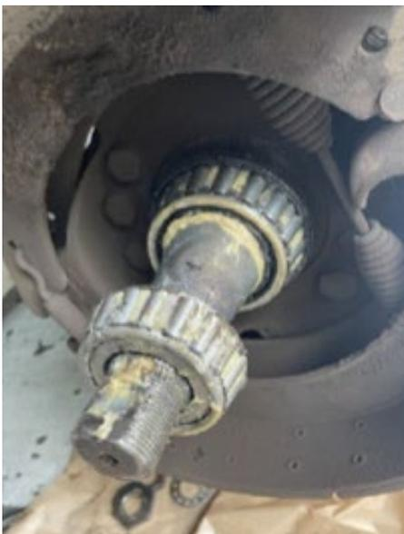
*Imagen 5. Grasa compleja de sulfonato de calcio aplicada en rodamientos.*
