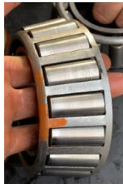
*Imagen 4. Daños evidenciados en el rodamiento.*
