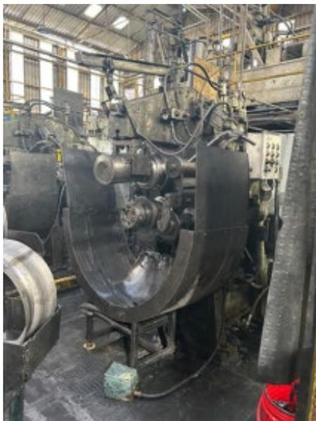
*Imagen 1. Máquina rolandora lubricada con grasa de litio.*
