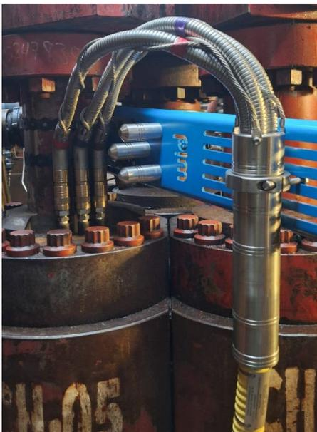
**Imagen 5.** Conector de superficie instalado en cabezal de pozo.
