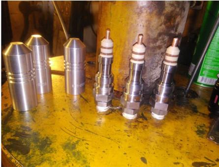
**Imagen 4.** Preparación de SST y ensamble de pines de conexión rápida
