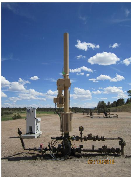
**Imagen 3.** Sistema de bombeo mecánico lineal (LRP®) controlado por un VFA dual.
