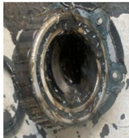
*Imagen 3. Grasa con base en microgel de consistencia semi-líquida*
