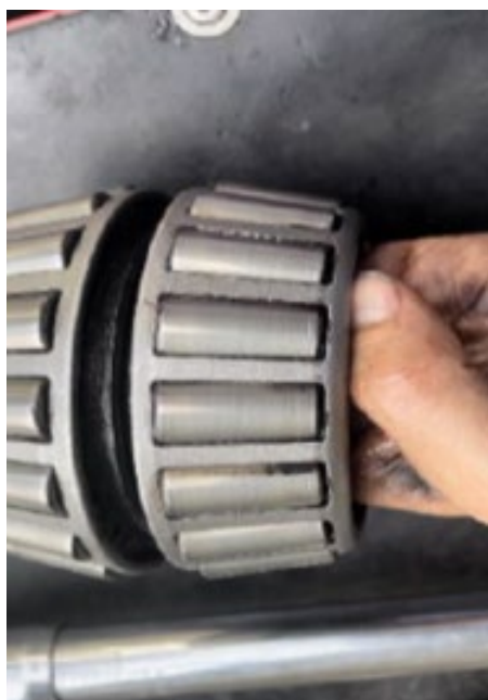
Imagen 6. Rodamientos en perfectas condiciones después de ejecutar pruebas de 27.000 kilómetros de uso.
