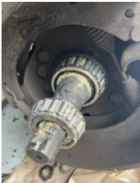
Imagen 5. Grasa compleja de sulfonato de calcio aplicada en rodamientos.
