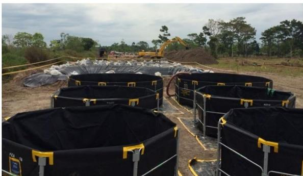
**Producto:** Tanques y diques de armado rápido
