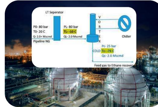
Sistema anti-congelamiento de válvulas piloto en reductores de presión.
