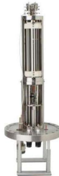
Espectrómetro de masa. Monitoreo de Iones Únicos, detección de iones positivos y negativos.
