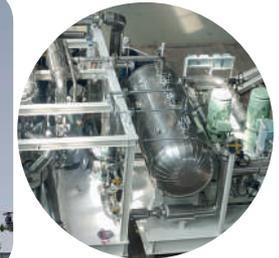
Entrega de gas natural con una concentración de agua inferior a 1 ppm y punto de rocío del agua inferior a  $-70^{\circ}\text{C}$ .
