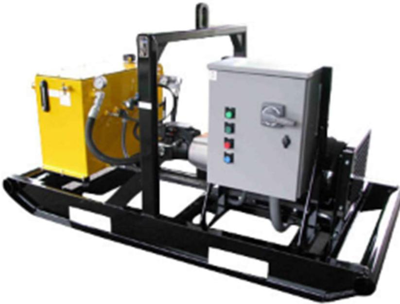
Sistema de conversión energética (Eléctrica-Hidráulica), para unidades de Registros Eléctricos, Registros de Producción y de Slick Line, con conexión de by pass proporcionando la posibilidad de trabajar el malacate con bomba del camión o bomba eléctrica, disminuyendo así las emisiones de CO<sub>2</sub> y los niveles de ruido en las operaciones.
