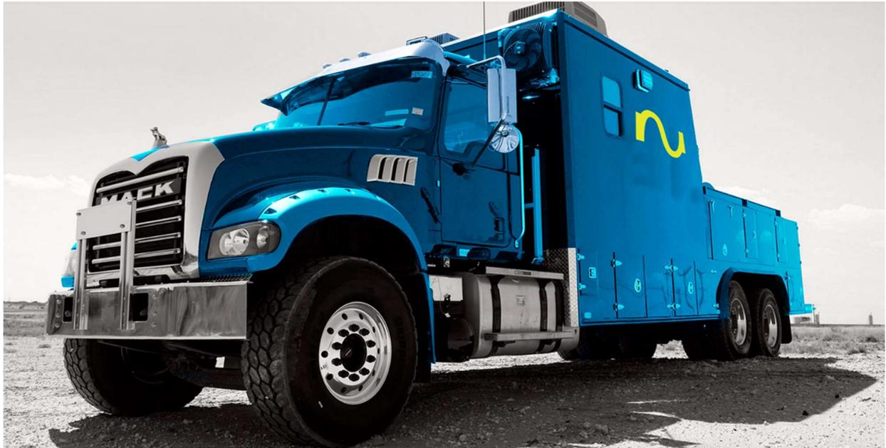
Unidad dual para toma de Registros Eléctricos y operaciones de Braided Line con principio de funcionamiento eléctrico que conlleva a una reducción significativa de emisiones de CO<sub>2</sub>.
