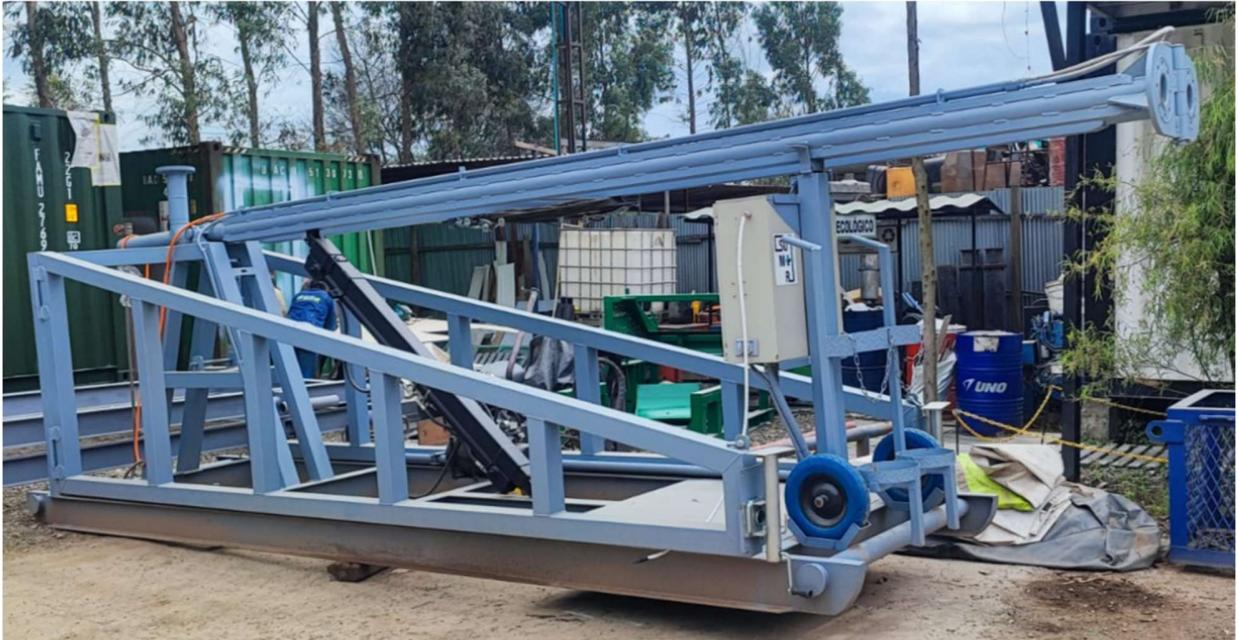
Sistema de Tea portátil auto soportada, con capacidad de 10 y 40 MMSCFD con sistema de auto izaje tipo pistón.
