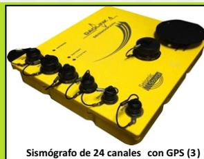
Sismógrafo de 24 canales con GPS (3)
