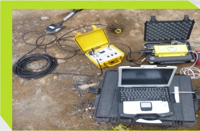
La sísmica paralela es un método de ensayo de pozo, similar al ensayo de Down Hole, desarrollado para la determinación de la profundidad de elementos de concreto (Pantallas, barretes, pilotes o caissons). Este método también podría detectar anomalías de gran magnitud dentro de la cimentación.
