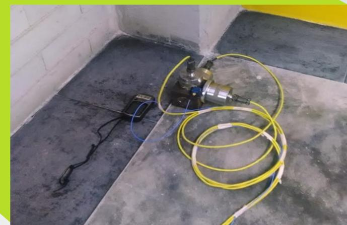
En ingeniería y arquitectura, la magnitud de las vibraciones de las estructuras (frecuencias, aceleraciones, velocidades, desplazamientos...) deben evaluarse en función de los criterios de aceptación o limitación de los valores tolerables. Adicionalmente, la medición de vibraciones en estructuras constituye un método práctico para determinar las características dinámicas básicas de un sistema estructural, tales como frecuencia natural de vibración, formas modales y amortiguamiento.
