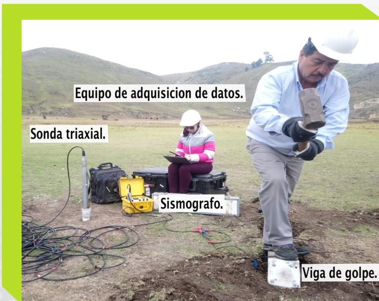
Procedimiento en campo para producción de ondas de corte tipo SH
