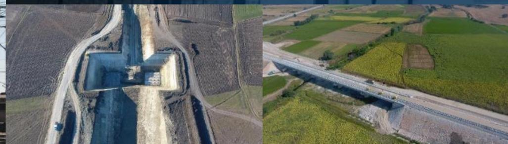
Supervisión de las obras de una nueva **línea de alta velocidad de 153 km**. La línea es de doble vía electrificada, con una velocidad de proyecto de **200 km/h**, y está equipada con **ERTMS/ETCS de nivel 1**. El objetivo de la línea es mejorar la **sostenibilidad y seguridad** del sistema de transporte nacional, así como establecer una conexión ferroviaria entre Turquía y la Unión Europea.
