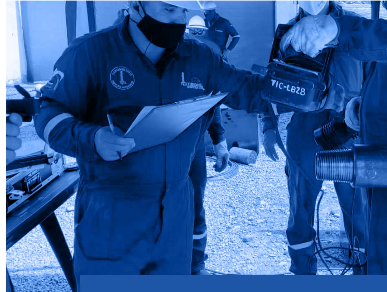
Somos especialistas en la inspección con ensayo no destructivos, identificando desgastes y otras desviaciones en varillas de producción.
