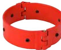
Disponible en tamaños desde aprox. 8cm hasta 50cm (3½ pulgadas a 20 pulgadas), este dispositivo ofrece una alta relación costo-beneficio. El collar articulado con una fila de tornillos de ajuste se posiciona con facilidad y firmeza alrededor de la tubería de revestimiento.
