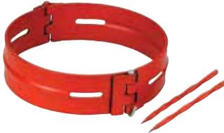
Este dispositivo, disponible en tamaños desde aprox. 8cm hasta 50cm (3½ pulgadas a 20 pulgadas), puede utilizarse en tuberías de revestimiento con y sin recalque para brindar máxima separación durante la rotación. Posee una ranura en el medio, en la cual se puede colocar una uña en forma de espiral para lograr un mejor agarre en la tubería.
