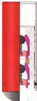
ZAPATA DE FLOTACIÓN
