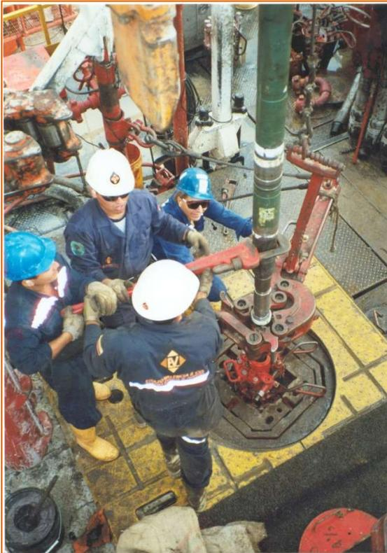
Contamos con herramientas de **DST** tales como: **Empaque de Prueba, Válvula de Cierre en Fondo, Válvula de Circulación, Válvula de Reversa, Registradores de Presión y Temperatura, y demás herramientas adicionales**, con las cuales se pueden realizar cierres en fondo, obtener muestras limpias de los fluidos de formación, facilitar las operaciones de completamiento y cañoneo, etc.
