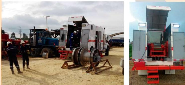
Para operaciones con cable eléctrico en hueco entubado, disponemos de camiones y unidades land y helitransportables para registros, dotados con sistema de superficie Warrior V8 y carretes duales de cables monoconductor Camesa de 7/32" y 5/16".
