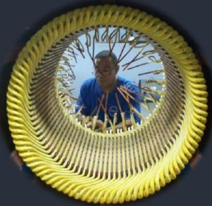
ESTADORES DE MEDIA TENSIÓN
